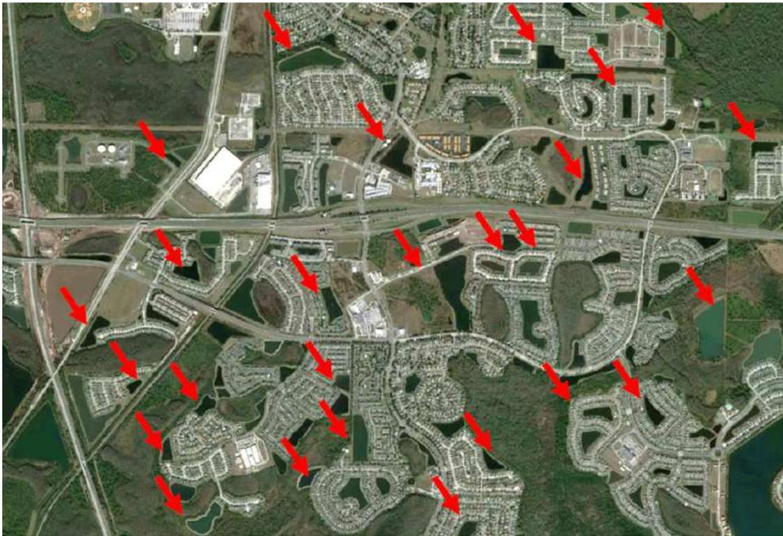
**Figura 36. Exemplo de estruturas compensatórias de drenagem: Sistema de bacias de retenção aplicadas na cidade de Kissimmee, Flórida, Estados Unidos. Fonte: Google Earth**
