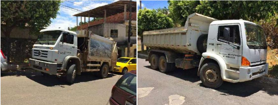
Figura 112. Fotografia do caminhão compactador utilizado na coleta de resíduos sólidos (esquerda) e caminhão caçamba utilizado na coleta (direita)
