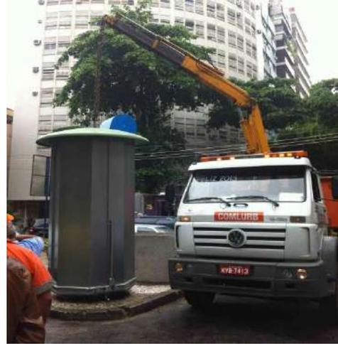
Figura 25. Caminhão realizando coleta
